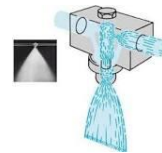
Schéma d'une buse d'atomiseur
