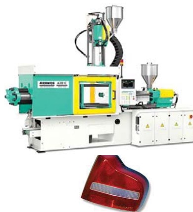
Fig. 10 : Injection Bi-matière ou Bi-couleur
