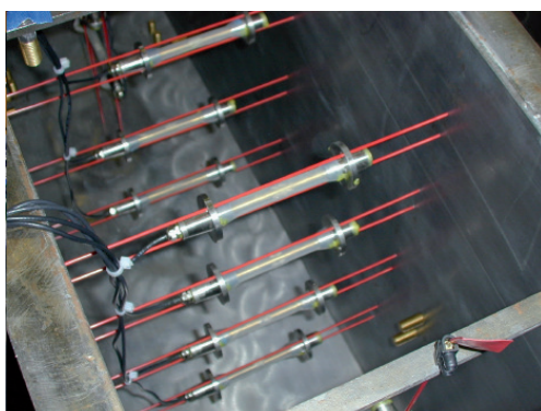
Cordes vibrantes sans raideur à l'intérieur d'un coffrage (IFSTTAR)
