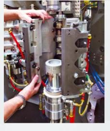
(1), enlèvement de chaque demi-moule (2) en relâchant trois vis, changement du fond du moule (3) au moyen d'un système mécanique (4) commandé par un dispositif mécanique (5), remplacement de l'arrêt de la barre d'étirage et sélection du nouveau type de récipient depuis le panneau de contrôle POSYC.
