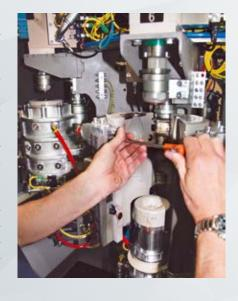
possible d'y accéder par deux côtés de la machine, grâce aux larges portes remontant verticalement. De plus, les temps de changement de format sont très réduits et permettent le passage rapide d'un format à l'autre, avec la reprise immédiate de la production. En effet, les paramètres de réalisation de chaque récipient sont mémorisés dans le panneau de contrôle POSYC, de façon que l'opérateur puisse sélectionner le type de récipient désiré directement depuis
